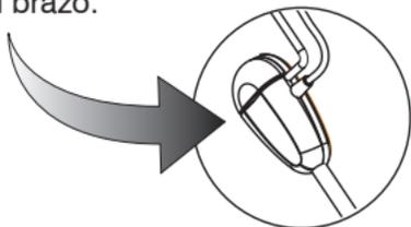
❷ Ponga el micrófono en la ESQUINA de la boca, de manera que la caja del micrófono quede a unos 12 - 25 mm (1/2 - 1 pulg) de la cara.
