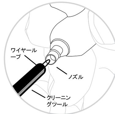
クリーニングの際には、イヤホンノズルの中に異物を押し込まないでください! イヤホンのサウンドフィルターが破損します。
