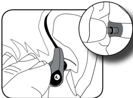
イヤパッドを取り替える際は、古いスリーブを注意して取り外し、新しいイヤパッドをノズルのつめの上にスライドさせてください。ノズルの一部が見えているのは、イヤパッドが適切に取り付けられていない状態です。ノズルにしっかりと装着しない場合はイヤパッドを取り替えてください。
