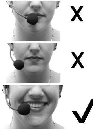
MISE EN PLACE DU MICROPHONE FIGURE 3
